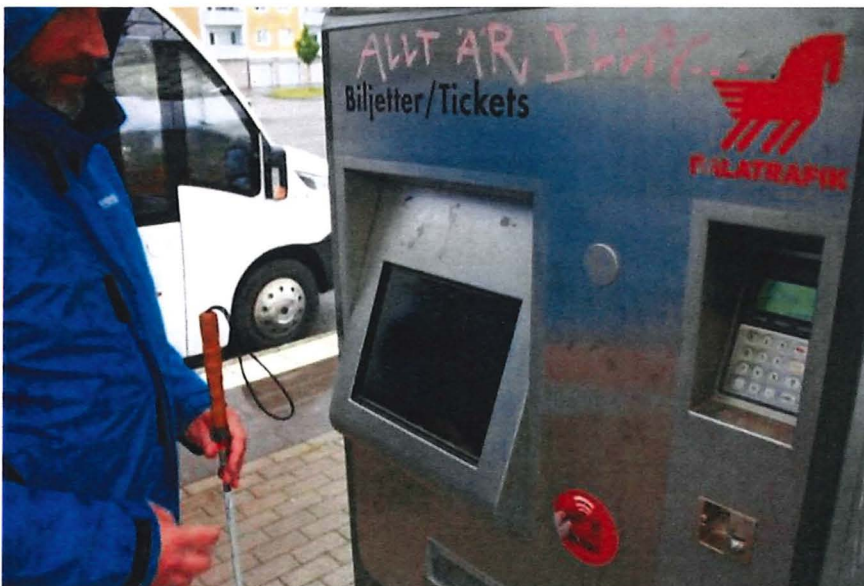
Figur 27: Biljettautomat för bussar är inte tillgänglig för synskadade. I dagsljus är det även för andra svårt att se vad som står på skärmen.
