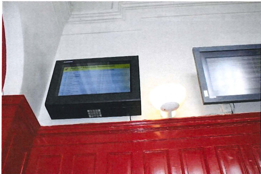
Figur 14: Mottjus på informationsskärmarna gjorde att det var svårt att se läsa av dem.
